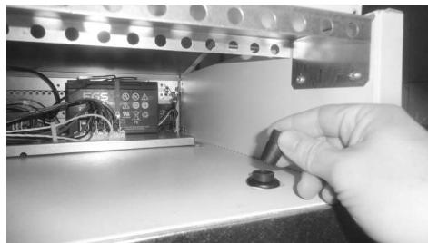
3. Entfernen Sie die beiden Gummistopfen an der Kabeleinführung (1 oben & 1 im Inneren des Gerätes).
