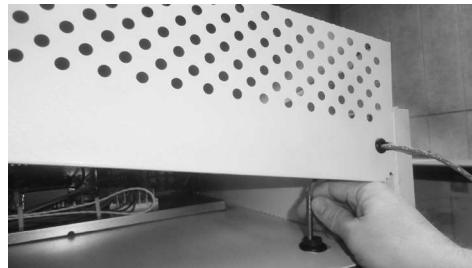
4. Führen Sie den Sensor durch die Abdeckungsbuchse und durch die Kabeleinführung in das Gerät.
