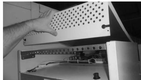
2. Heben Sie die Abdeckung an und legen Sie sie auf die Geräteoberseite.
