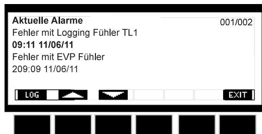
5. Drücke die **LOG** Taste um ins **Protokolierte Alarne** zu gelangen. Dieses Menue enthält alle gespeicherten Alarne. Für jeden Alarm ist Start und Ende mit Zeit und Datum festgehalten..
