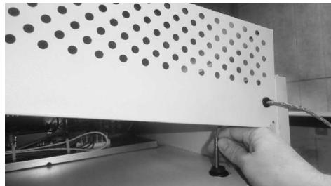
4. Guidez le capteur à travers de la douille de protection du couvercle supérieur, à travers du trou de passage et dans l'appareil.
