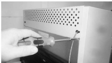
6. Legen Sie die obere Abdeckung in die geschlossene Position, beide Schrauben einsetzen und festdrehen.
