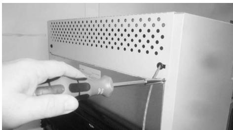
6. Placez le couvercle supérieur en position fermée et remontez les deux vis (TX20).
